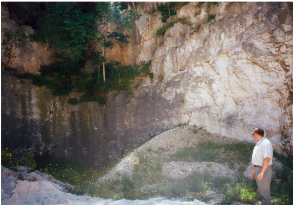
Slika 18.5. - Ostaci stare tehnike vađenja blokova (pašarin) u kamenolomu Sv. Nikola
