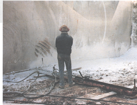
Slika 10.11. - Horizon - pomoćni uređaj pri bušenju horizontalnih bušotina bušačim čekićem
