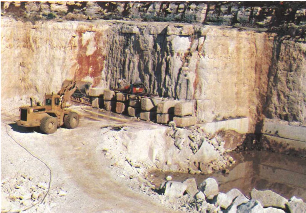
Slika 8.5. - Podsjecanje otkrivke lančanom sjekačicom u kamenolomu Kanfanar
