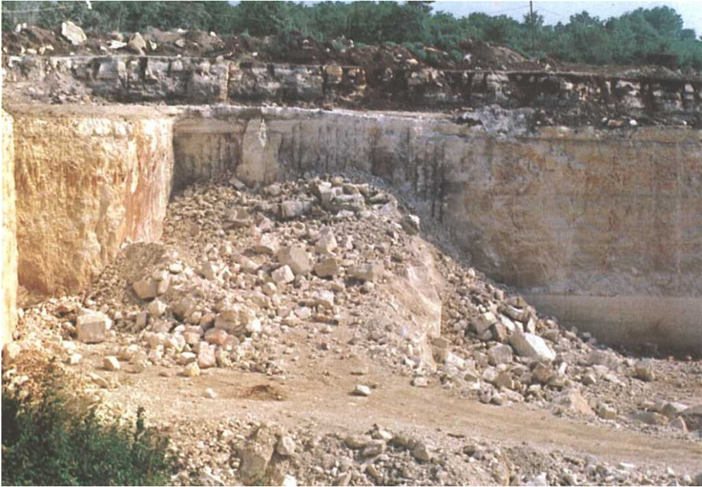
Slika 8.6. - Odminirana otkrivka prespliting miniranjem u kamenolomu Kanfanar
