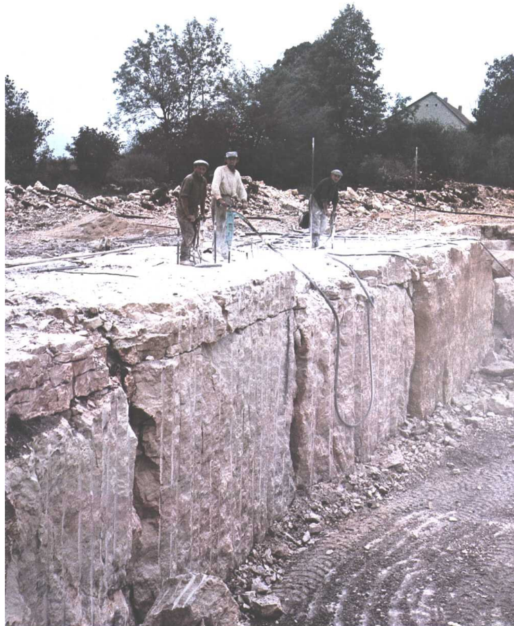
Slika 8.1. - Kamenolom s tankim jalovinskim humusnim slojem i tankim jalovinskim slojem čvrstog kamena
