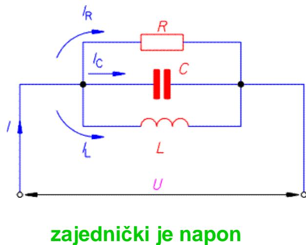
$$I_R = \frac{U}{R} \quad I_L = \frac{U}{j\omega L} = -j \frac{U}{\omega L} \quad I_C = U \cdot j\omega C = jU\omega C$$
