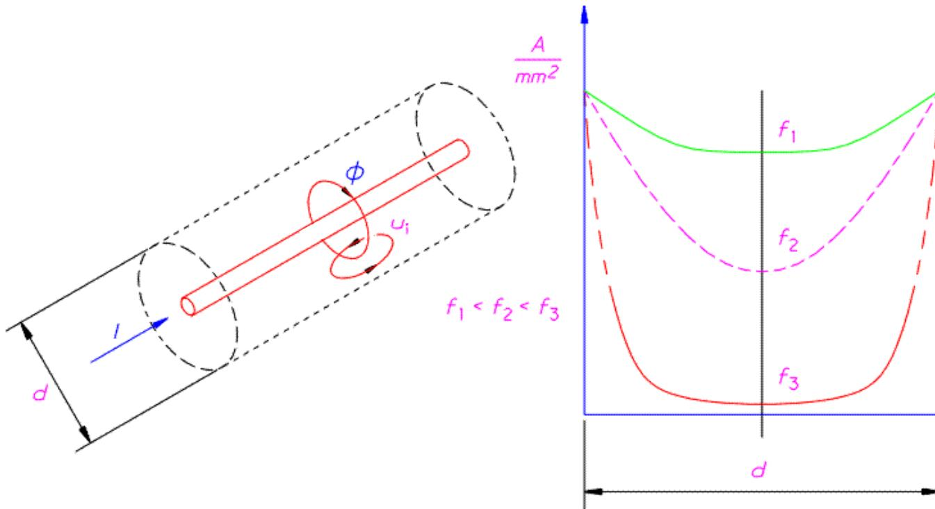
**skin efekt  $\Rightarrow$  potiskivanje struje prema vanjskom dijelu vodiča**
