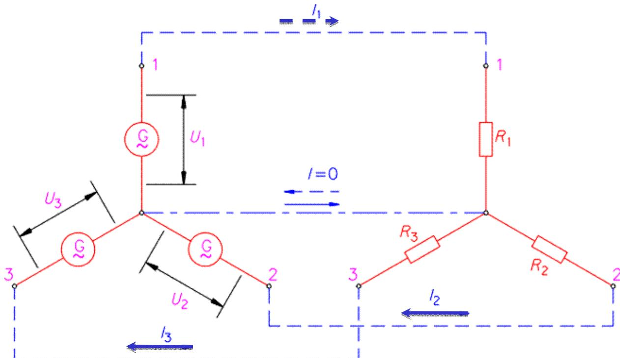
uz  $R_1 = R_2 = R_3 = R_f$  i  $U_1 = U_2 = U_3 = U_f$  slijedi  $I_1 = I_2 = I_3$
