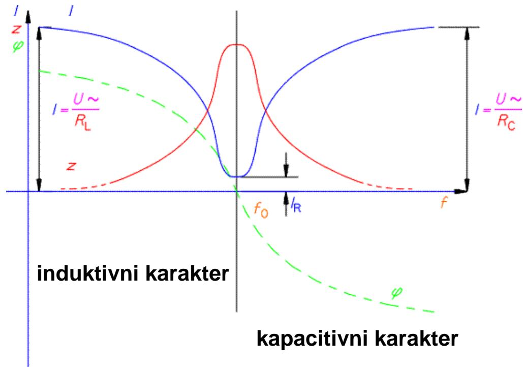
ako nema otpornih komponenti titrajni krug prema vani djeluje kao izolator ali unutar njega teku vrlo velike struje
