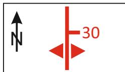
vertikalna osna ploha sinklinale s pružanjem  $90-270^\circ$
